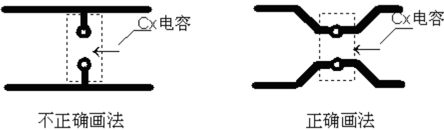
图 67 电容的引线最短
